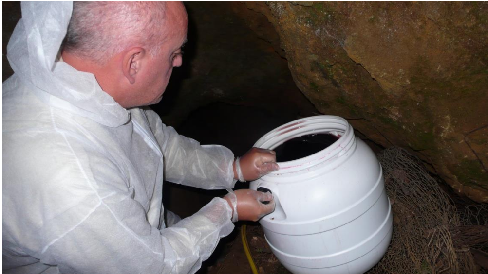
Injection de 10 kg de naphthionate de sodium dans la diaclase de Rouffiat
