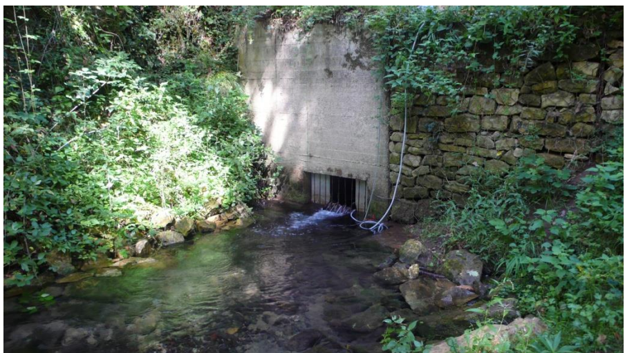
Figure 48 : Crépine d'aspiration du préleveur et sonde du fluorimètre de terrain
