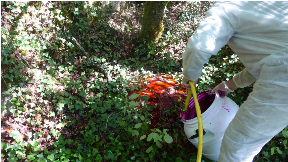
Injection de 4 kg de sulforhodamine B dans la dépression de Génébrier
