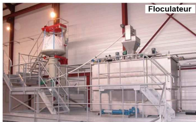
Illustration 2 : Clarificateur et flocculateur (circuit des eaux de l'installation)
