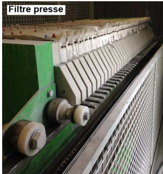
Illustration 3 : Filtre presse et déstockage des galettes d'argile
