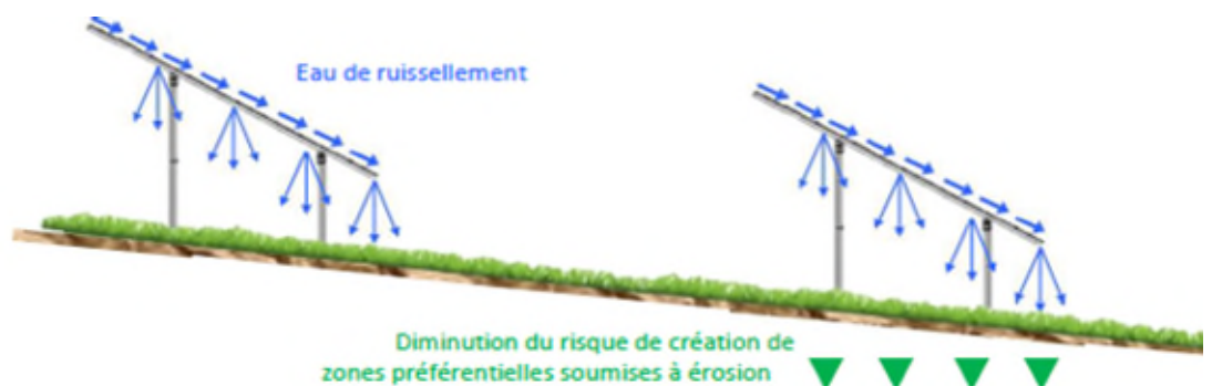
Figure 13 : Les panneaux laissent passer l'eau pluviale
