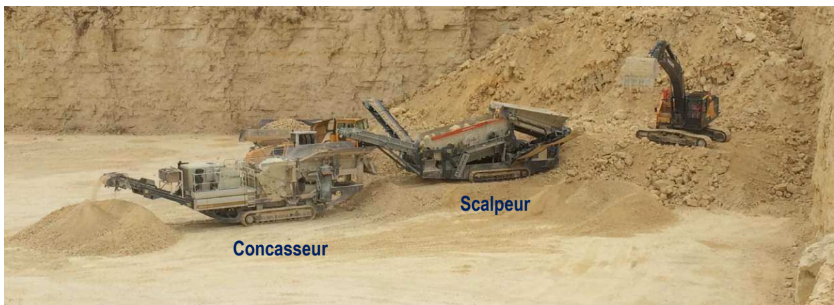
Illustration 4 : Groupes mobiles scalpeur et concasseur
