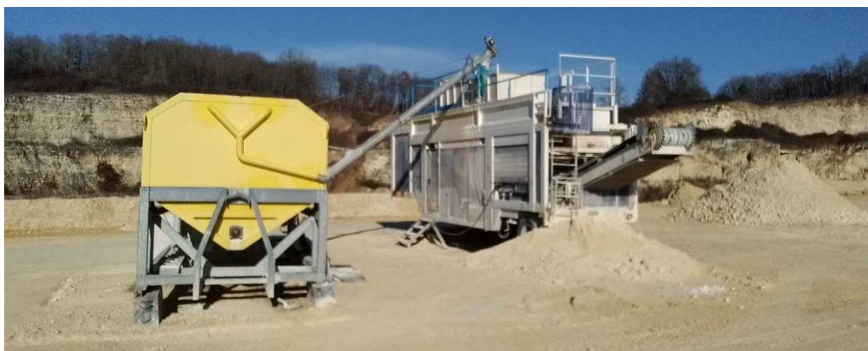
Illustration 5 : Unité mobile de chaulage
