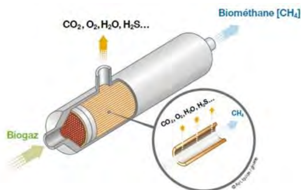
Figure 12 : Module membranaire et principe de fonctionnement (Air Liquide)
